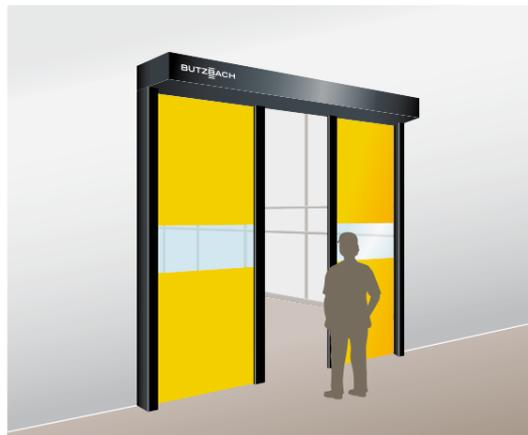
Un classique Butzbach de par son type de construction, une porte rapide de la dernière génération d'un point de vue technique : le mécanisme à ressort tire simultanément les deux vantaux et les enroule dans un support compact. Avec l'option supplémentaire « Sprint », la porte atteint une vitesse de pointe maximale de 5 m/s. Elle se referme immédiatement à l'aide d'un moteur électrique fiable.
