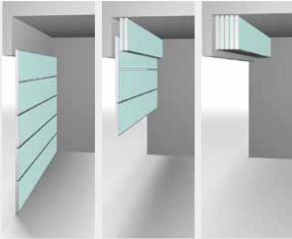
A l'ouverture, les éléments s'empilent verticalement à l'abri derrière le linteau avec un minimum d'encombrement évitant toutes détériorations pendant les trafics et s'adaptant à l'environnement existant (éclairage, gaines, ponts roulants...)
