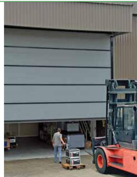
Les parties latérales mobiles permettent d'utiliser la totalité de l'ouverture du bâtiment. Si les parties latérales sont grandes avec des portes intégrées, l'ouverture s'effectue par pivotement ou coulissement.
