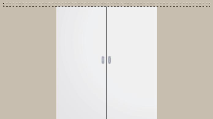
Coulissant dans le mur : le panneau de porte se range dans une niche murale à la charge de l'utilisateur, tandis que l'hubriserie recouvre entièrement l'ouverture de paroi.
