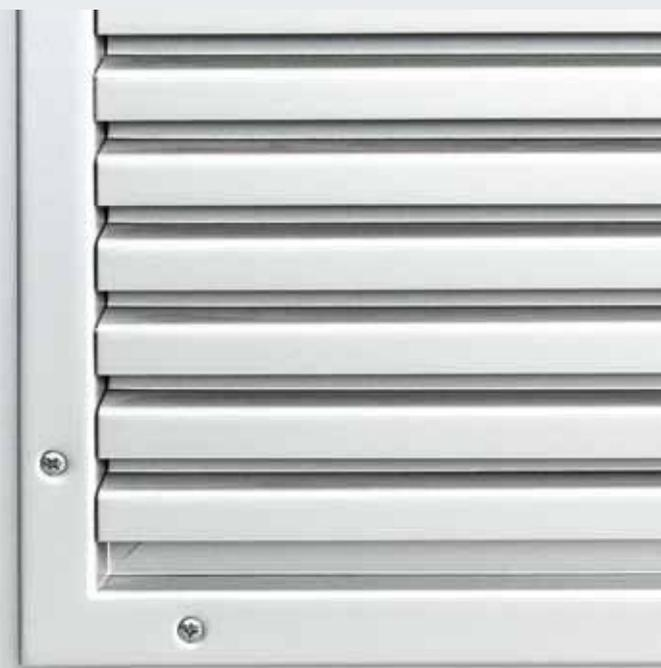
Toutes les grilles d'aération sont en tôle d'acier à l'épreuve de la perforation avec tôle perforée intérieure. Elles sont galvanisées et dotées d'un revêtement d'apprêt à base de poudre en blanc gris (comparable au RAL 9002).
