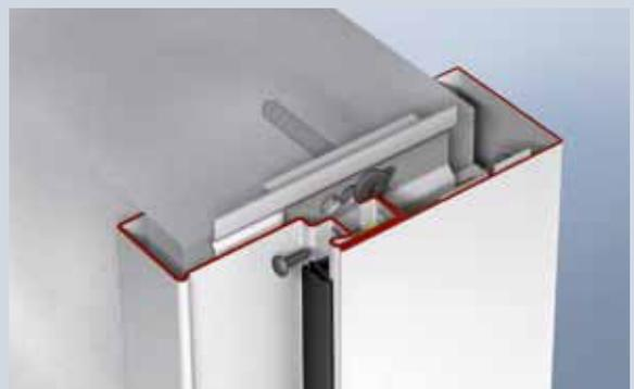
Vissage du profilé de contre-huisserie 2 sur l' huisserie du profilé 1 à travers la rainure d'étanchéité, puis recouvrement avec le joint de porte
