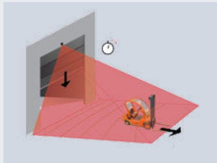
Le champ du laser fait office de « gardien » fiable. Il détecte la direction et la vitesse d'un objet en déplacement et assure donc des temps de réponse optimaux à l'ouverture et à la fermeture. Les temps d'immobilisation porte ouverte sont réduits au maximum, pour une économie d'énergie.
