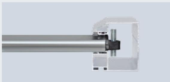
Rideau à lames DD, profilé Decotherm S, avec crochet anti-tempête en acier (à partir de 5000 mm de largeur et/ou de hauteur ou, en option, à partir d'une exigence de charge au vent plus élevée)
